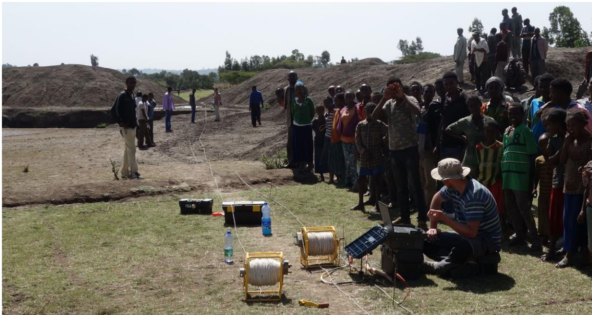
Obrázek č. 6: Měření metodou VES – GEA 4 s bubny A a B 660 m, s AB 1320 m
