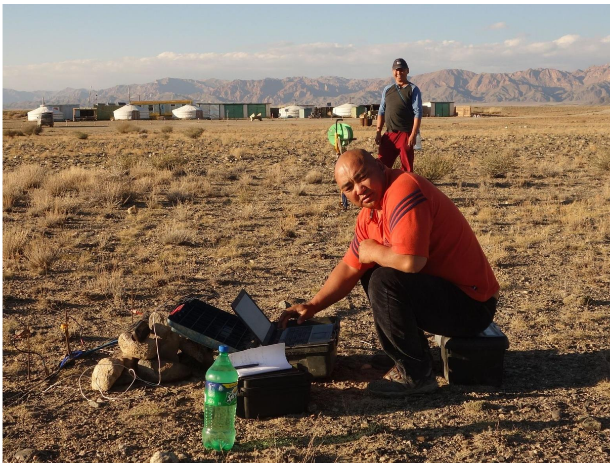
Obrázek č. 7: Měření metodou VES – GEA 4 s mobilními bubny na elektrodách A a B – 392 m
