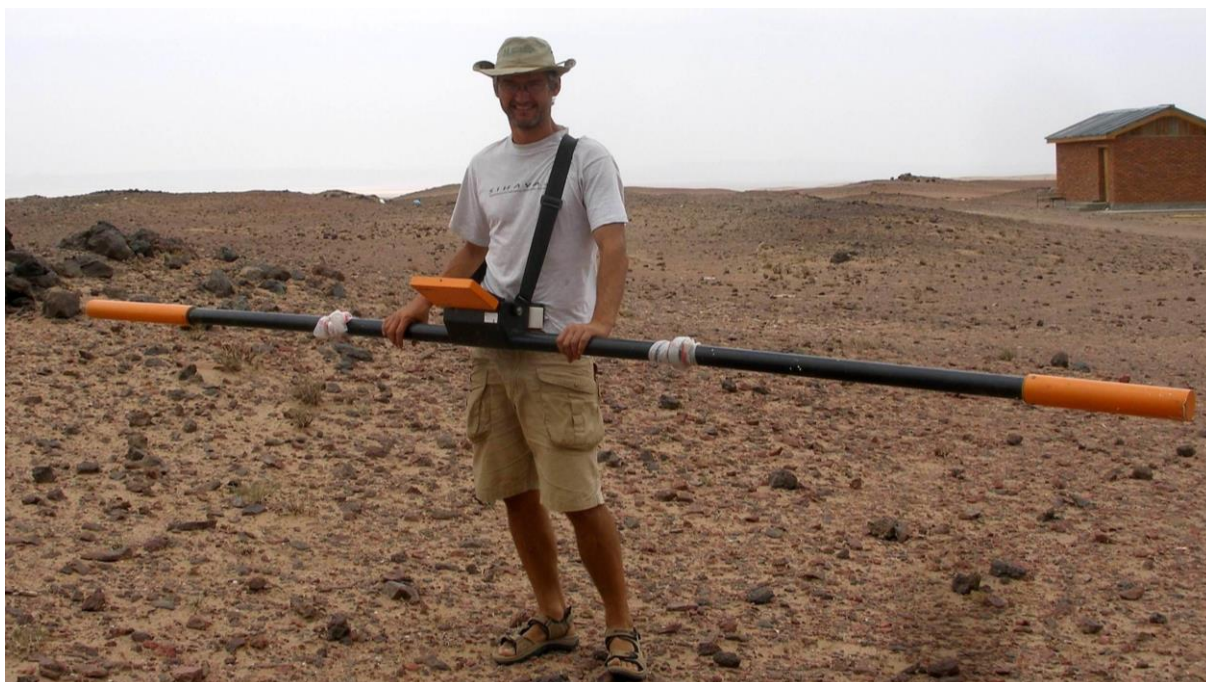
Obrázek č. 2: Měření metodou DEMP – přístroj CM031
