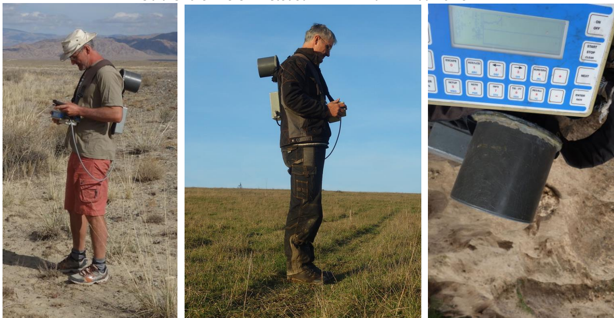
Obrázek č. 3: Měření metodou VDV – křivka VDV nad zlomem
