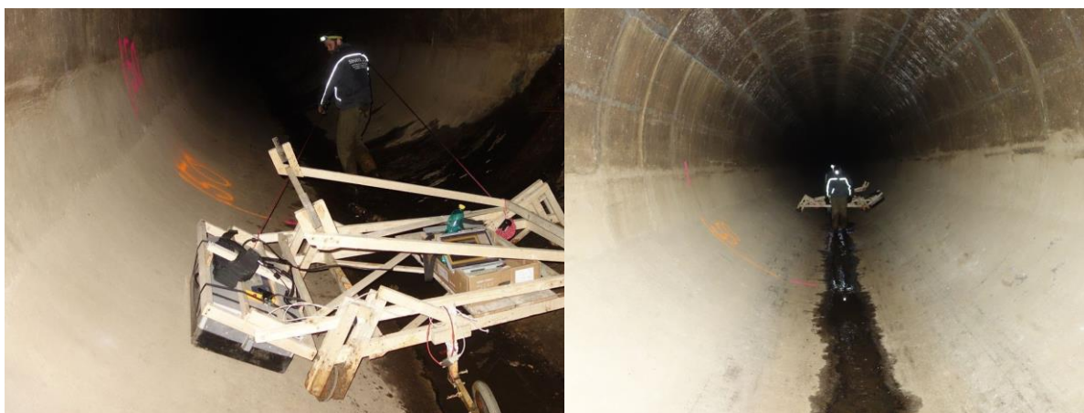
Obrázek č. 10: Měření georadarem Ramac X3M s přitlačným mechanismem pro stěnu tunelu
