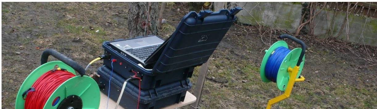
Obrázek č. 5: Měření metodou VES – GEA 6 s elektrodami 391 m (AB 782 m)
