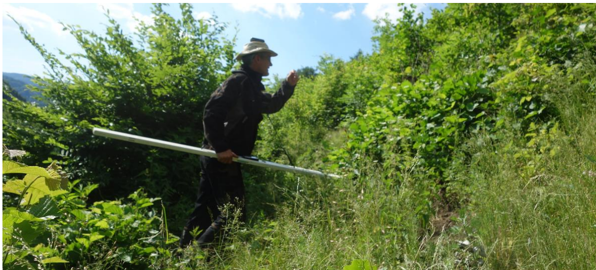
Obrázek č. 1: Měření metodou DEMP – přístroj GEM 2-181
