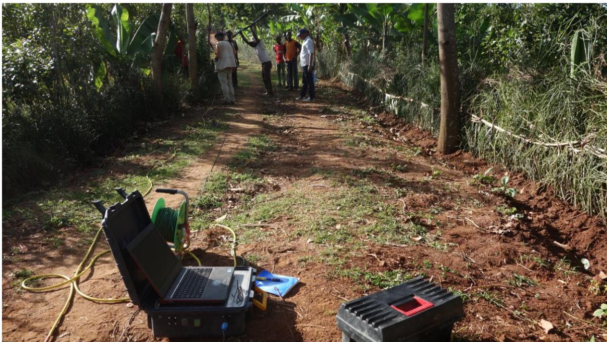
Obrázek č. 4: Měření metodou MRRS – Seismut 6
